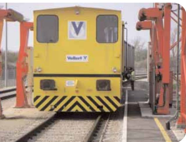
Verschubroboter für ferngesteuerten Verschub
